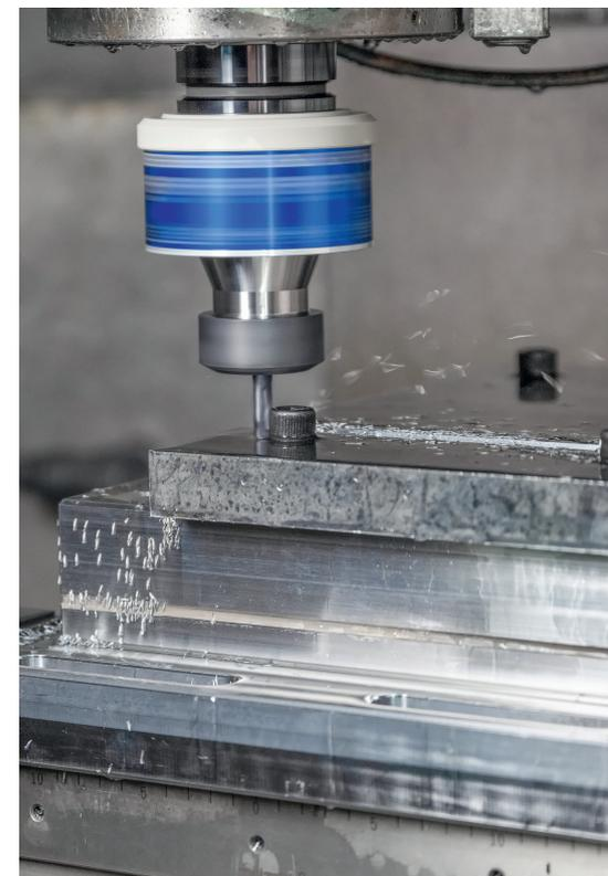
3 Das neue kabellose, rotierende Dynamometer (Typ 9170) von Kistler misst die in der Zerspanung auftretenden Kräfte © Kistler
